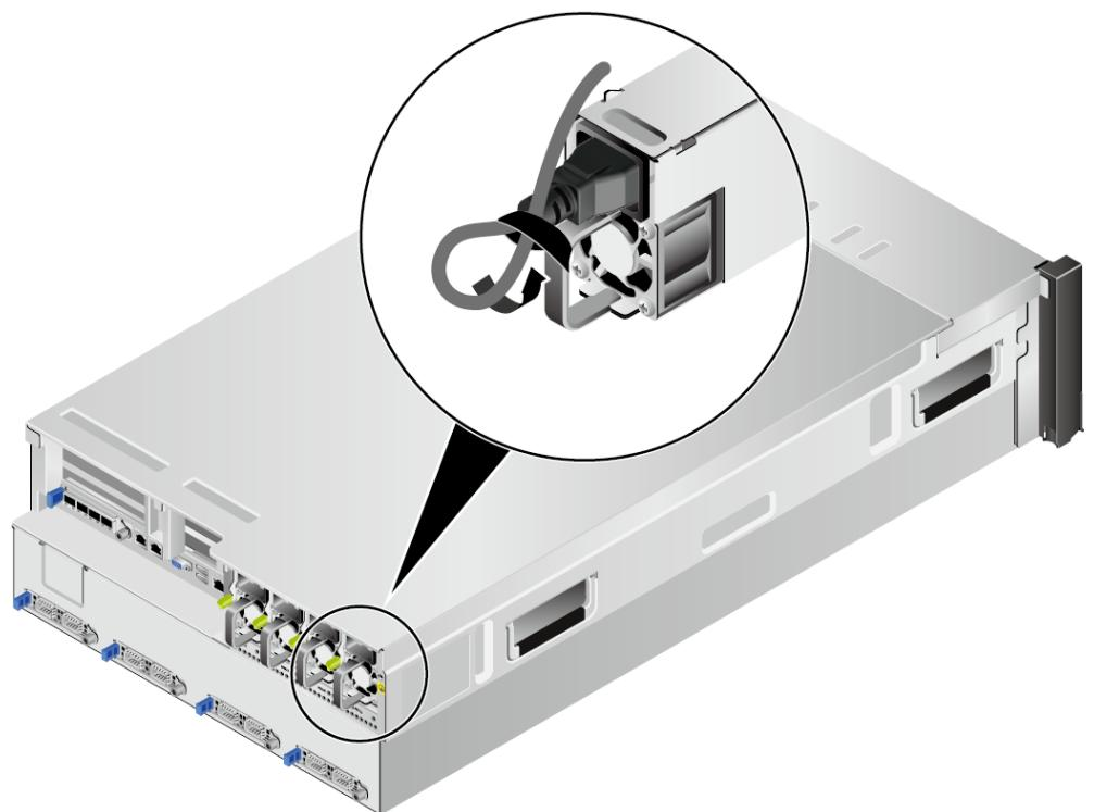
**步骤4** 将电源线的另一端插入机柜的交流插线排。交流插线排位于机柜后方，水平固定在机柜上。按照规划选择合适的交流插线排上的插孔插入电源线。
