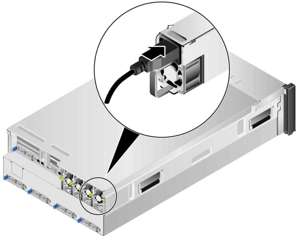
步骤3 用魔术贴固定好电源线缆，如图5-29所示。
