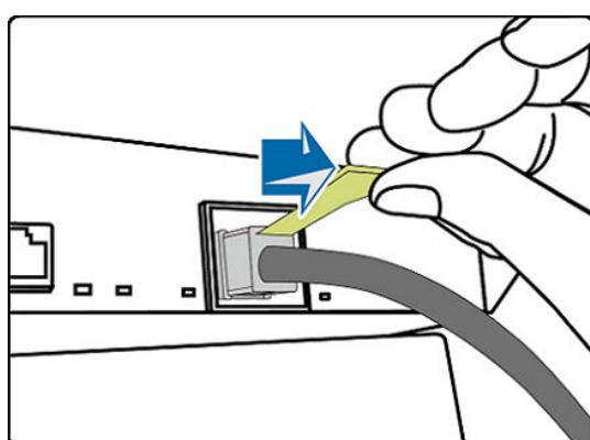
3. 将线缆垂直插入端口中，如图5-27所示。
