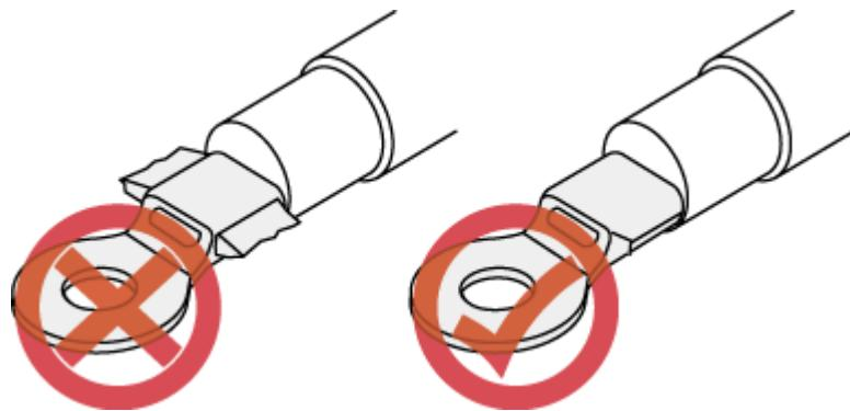
图 A-9 裸压接端子尾部与电源电缆导体接触部分压接(OT 端子)
