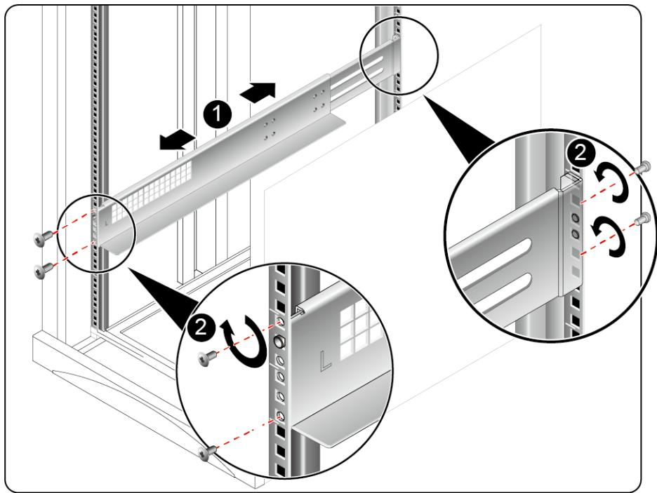
3. 如图5-10中②所示，用螺丝刀拧紧滑道的前后4颗紧固螺钉。
