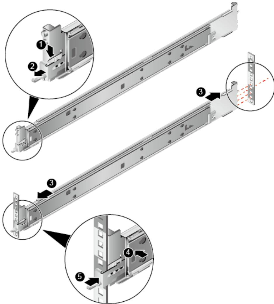
2. 将抱轨后端定位销，插入机柜后侧的立柱孔位，如图5-12中③所示。
