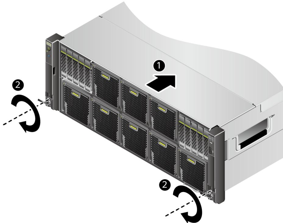
3. 如图5-7中②所示，将设备两侧挂耳紧贴方孔条，按顺时针方向拧紧挂耳上的松不脱螺钉，固定设备。
