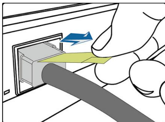
图 5-26 从下向上仰视线缆拔出示意图
