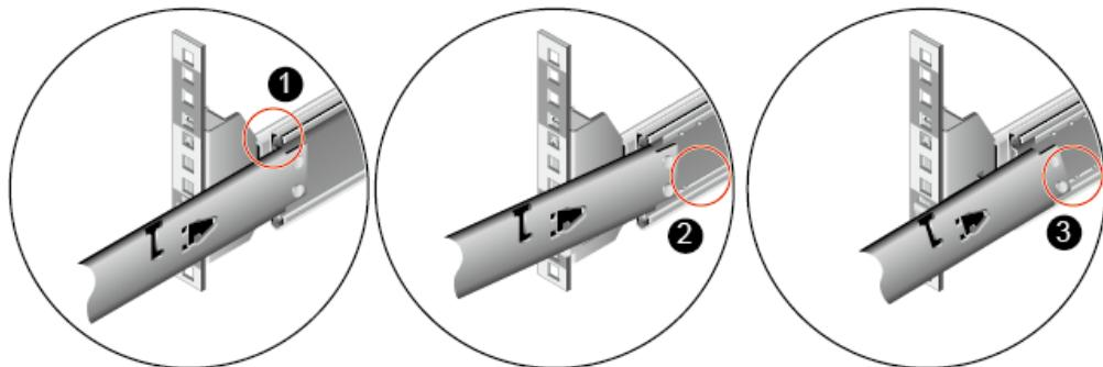
4. 按住设备两侧的解锁按钮，将设备推入抱轨，如图5-17中①、②所示。
