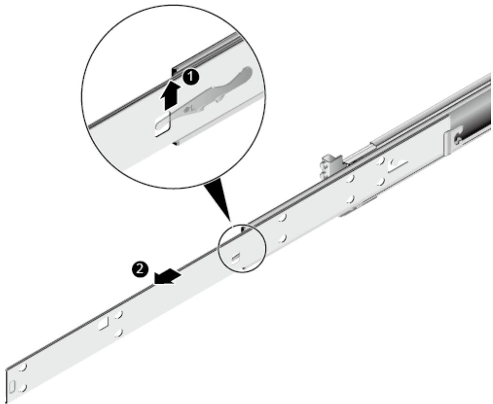
2. 将设备上的固定钉对准内轨的固定孔，沿箭头方向推动内轨，直到听见“咔”的一声，确保卡扣弹起完全挡住挂钉，使设备固定到内轨上如图5-14所示。
