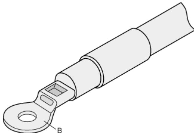
**步骤5** 将热缩套管“A”往连接器体的方向推，并覆盖住裸压接端子与电源电缆导体的压接区，使用热风枪将热缩套管吹缩，完成裸压接端子与电源电缆的装配，如图A-10所示。
