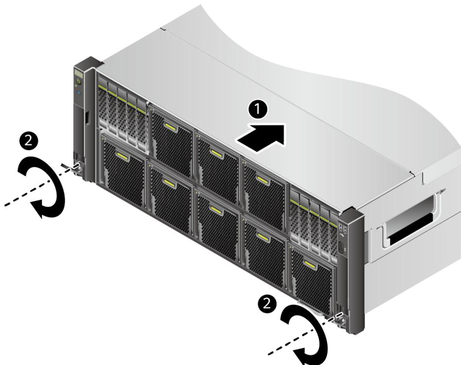
3. 如图5-11中②所示，将设备两侧挂耳紧贴方孔条，按顺时针方向拧紧挂耳上的松不脱螺钉，固定设备。
